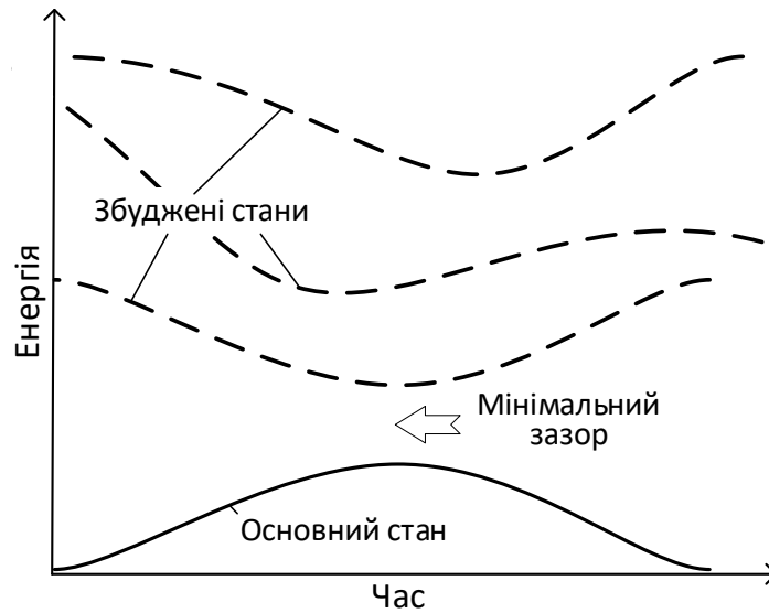
РИС. 1. Спектр власних значень (енергетичних станів) квантової обчислювальної системи
