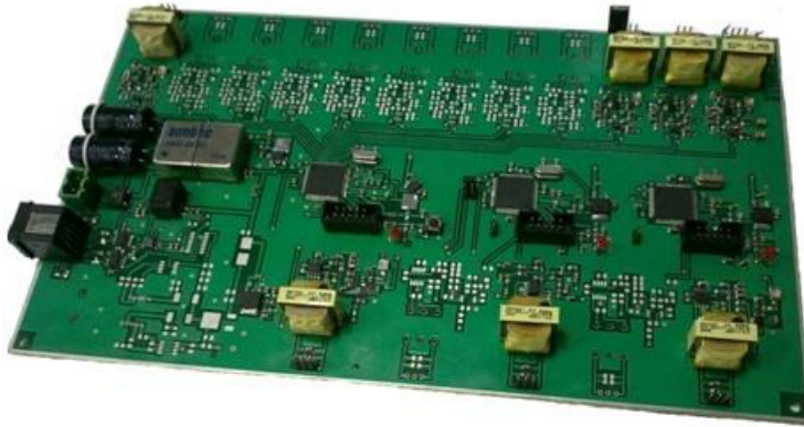
Рисунок 6.6 – Плата адаптера аналогового каналу
