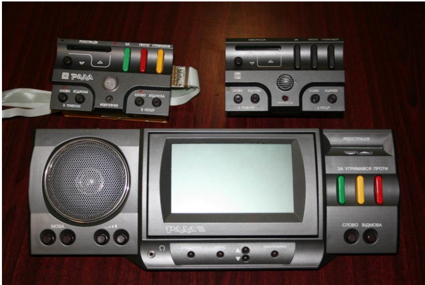
Рисунок 2.2 – Пульти систем «Рада», «Рада-2» та «Рада-3»
